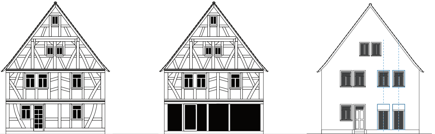
Schaufenster früher und heute - für funktionslose Schaufenster empfiehlt sich ein Rückbau nach historischem Vorbild
